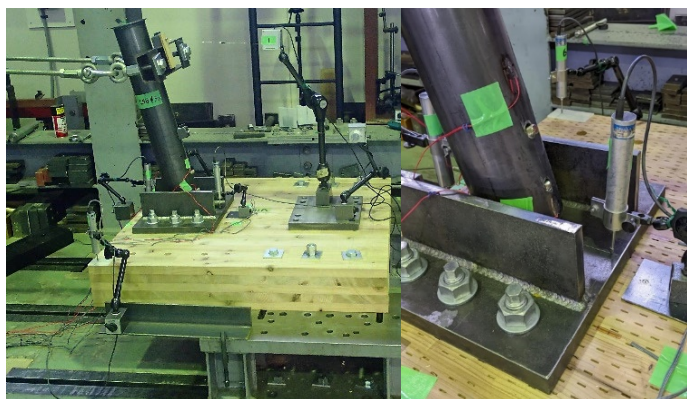
図5 支柱の変形とベースプレート接合部 (LSB30d)
