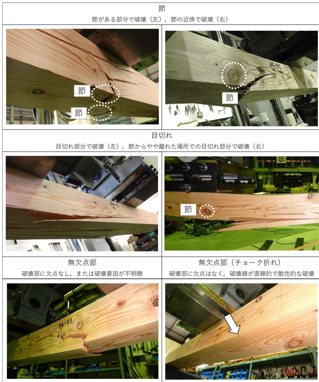
写真1 曲げ破壊の代表例
