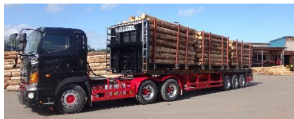
写真1 トドマツ積込試験に供試した原木輸送専門車両（左：運材車、右：セミトレーラ）
