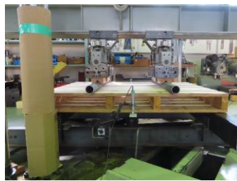
図 3 曲げ試験実施状況
