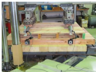
図6 下面デッキボード試験実施状況
