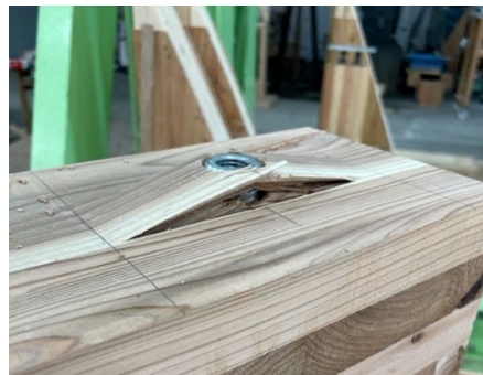
図4 試験後の接合部 (LSB30t)
