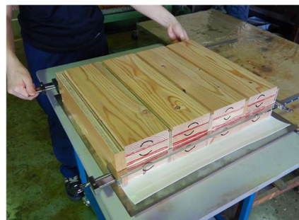
写真2 実験室での試験体の作製 ① 製造条件の異なる集成材
