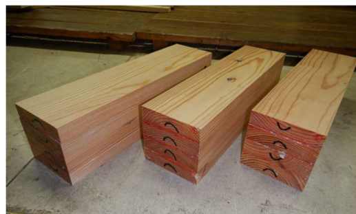
写真3 作製した試験体 ① 製造条件の異なる集成材
