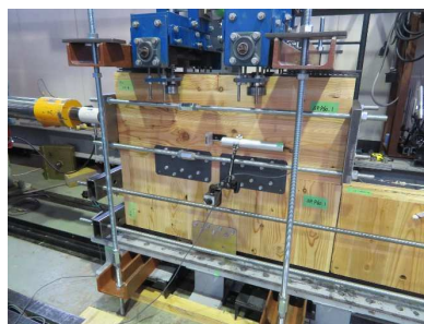
せん断金物試験体
