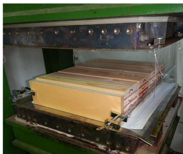
写真2 実験室での試験体の作製 ① 製造条件の異なる集成材
