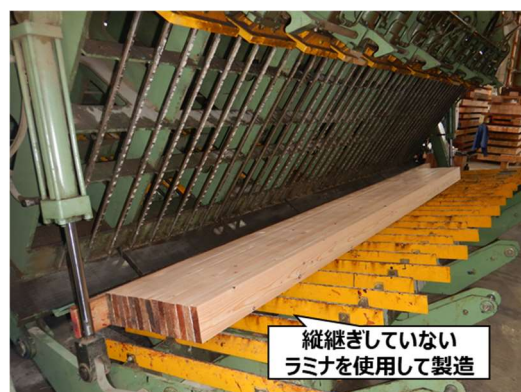
写真4 工場での集成材の製造
