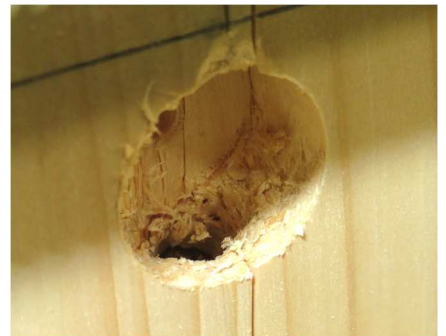
図 6 試験後の状況 ビス頭（試験前），ビス頭のめりこみ（試験後）
