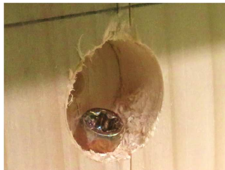
図 6 試験後の状況 ビス頭（試験前），ビス頭のめりこみ（試験後）
