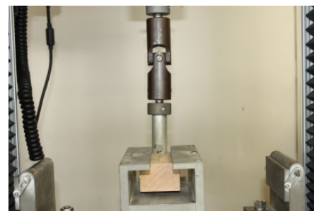
写真 2 木ねじ引き抜き試験
