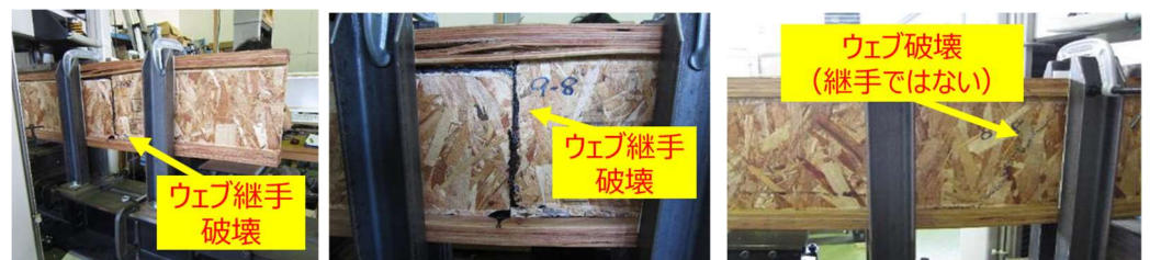
図6 実大材のせん断試験の破壊例
