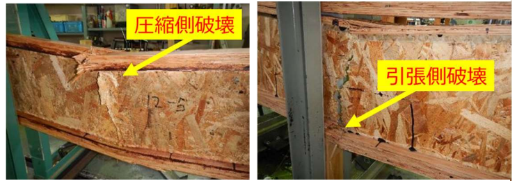
図5 実大材の曲げ試験の破壊例
