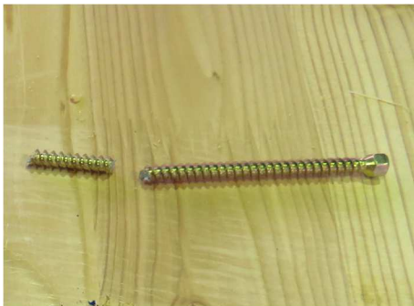
図 5 試験後の状況 ビスの破断
