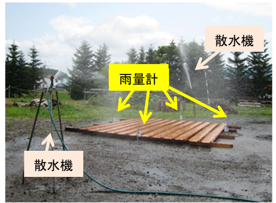
図 2 実大材（曲げ試験体）の散水処理
