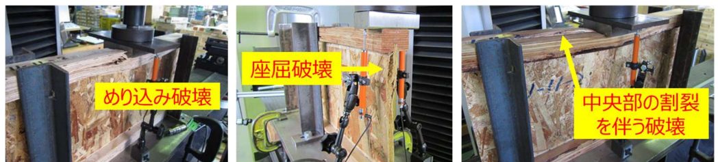
図7 実大材のめり込み試験の破壊例
