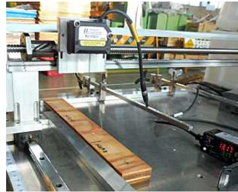
図 2. 反り量の測定の様子
