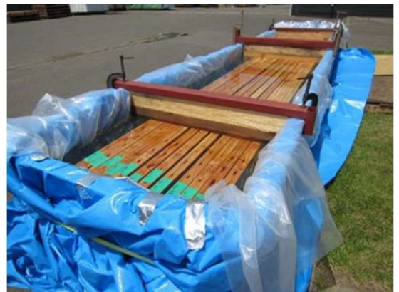
図 3 実大材（曲げ試験体）の浸せき処理
