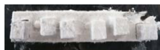
Figure 2. 木酢液処理9週目の褐色腐朽 (左: EtOH処理、右: MC 0.25g/mlの木酢液処理)
