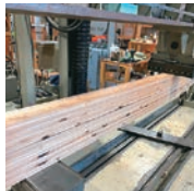
集成材の曲げ試験
