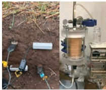
センサーによる土壌水分観測と土壌内の物質移動実験
