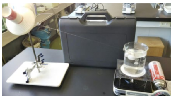
図1. 煮繭にはカセットコンロとビーカーを用い、市販の糸巻き器を利用した自作の繰糸器
